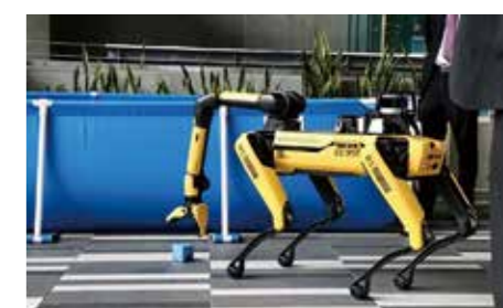
■ 波士頓動力機械狗Spot能靈巧執行抓取、偵測等任務
