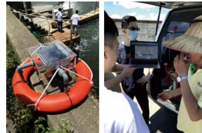
■ 水質監測感測器 ■ 計畫團隊教導漁民使用遠端伺服器
